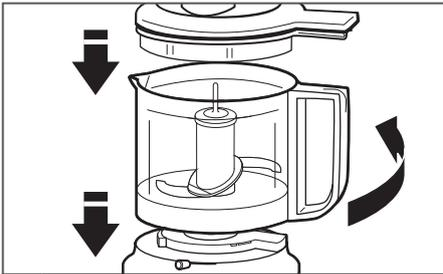
**1** Setzen Sie den Deckel so auf die Arbeitsschüssel, dass der Griff nach vorn zeigt. Drehen Sie den Deckelgriff nach rechts. Drehen Sie den Deckel zum Verriegeln gegen den Uhrzeigersinn.
