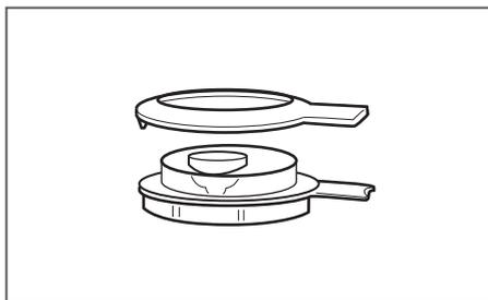
**OPTIONAL:** Der Deckelring kann für eine noch gründlichere Reinigung bei Bedarf abgenommen werden.
