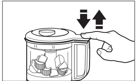
**2** Drücken Sie mehrfach schnell auf die **IMPULS-/EINSCHALTASTE**, damit die Zutaten in der Arbeitsschüssel verarbeitet werden.
