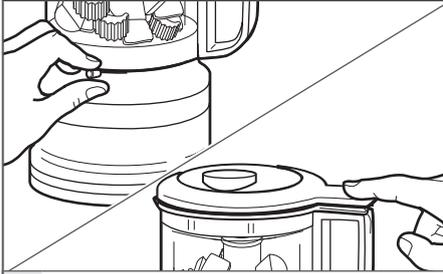
**5** Stellen Sie die gewünschte Geschwindigkeitsstufe ein. Drücken Sie die **IMPULS-/EINSCHALTASTE**, um den Mini-Food-Processor zu starten. Legen Sie nach maximal 30 Sekunden eine Pause ein.
