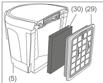
3. Entnehmen Sie den Schaumstofffilterrahmen (29) und den Schaumstofffilter (30).
