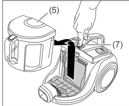
3. Drücken Sie die Entriegelungstaste für den Staubbehälter (7), und nehmen Sie den Staubbehälter (5) am Tragegriff ab.
