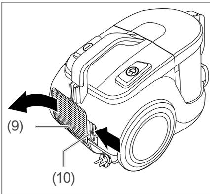
2. Nehmen Sie die Filterabdeckung (9) ab. Drücken Sie dazu die Entriegelung für die Filterabdeckung (10)
