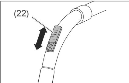
Bei Bedarf können Sie die Saugkraft mithilfe des Nebenluftventils (22) weiter verringern. Die Abdeckung des Nebenluftventils (22) lässt sich stufenlos verschieben.
