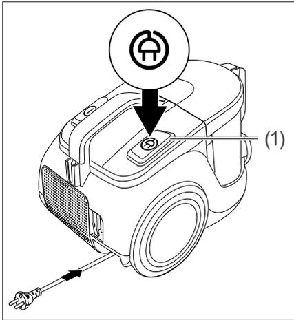
3. Drücken Sie zum Aufwickeln des Netzkabels (11) auf den Fußschalter für die Kabelaufwicklung (1). Halten Sie dabei das Netzkabel am Netzstecker in der Hand, um einen eventuellen „Peitscheneffekt“ zu verhindern.
