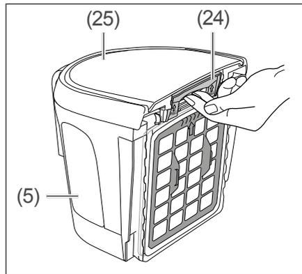
4. Lösen Sie die Arretierung (24) unter dem Staubbehälterdeckel (25) und nehmen Sie den Staubbehälterdeckel ab.
