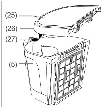
6. Setzen Sie den Staubbehälterdeckel (25) wieder auf den Staubbehälter. Achten Sie dabei darauf, dass die Halterung (26) am Staubbehälterdeckel in die Aussparung (27) am Tragegriff des Staubbehälters eingreift.
