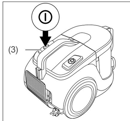
1. Drücken Sie mit dem Fuß auf den Fußschalter Ein/Aus (3), um das Gerät auszuschalten.
