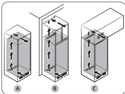
Der Luftauslass muss je nach Art des Schrankes so wie in einem der folgenden Beispiele oder in einer ähnlichen Position angeordnet werden.
