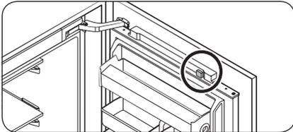
3. Entfernen Sie die PE-Schaumfolie von dem Magneten oben an der Tür.
