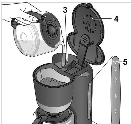
3. Entsprechende Menge frischen, kalten Leitungswassers in den Wasserbehälter **3** füllen.
