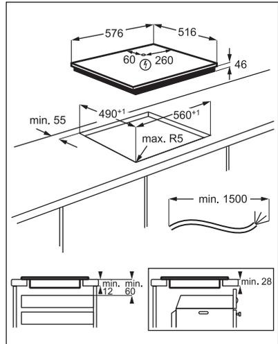
**i** Ist das Gerät über einer Schublade installiert, kann die Kochfeldbelüftung die in der Schublade aufbewahrten Gegenstände während des Garvorgangs erwärmen.
