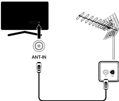
1. Um digitale terrestrische Kanäle (DVB-T), digitale Kabelkanäle (DVB-C) oder analoge Rundfunkkanäle zu empfangen, schließen Sie das Antennenkabel an die Buchse **ANT IN** am Fernsehgerät an.
