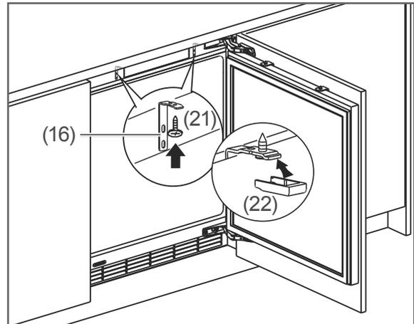
16. Befestigen Sie die Winkel (16) mit den Schrauben (21) an der Arbeitsplatte.
