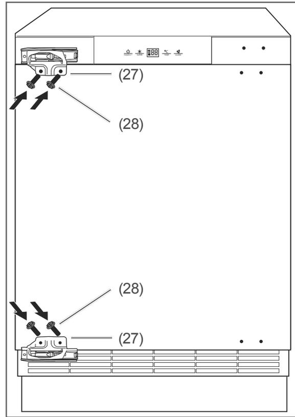
6. Befestigen Sie die Scharniere (27) mit den Schrauben (28).
