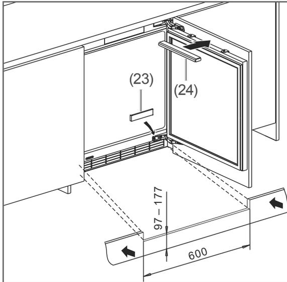
19. Stecken Sie die Schraubenabdeckung (24) auf die Doppelschrauben.
