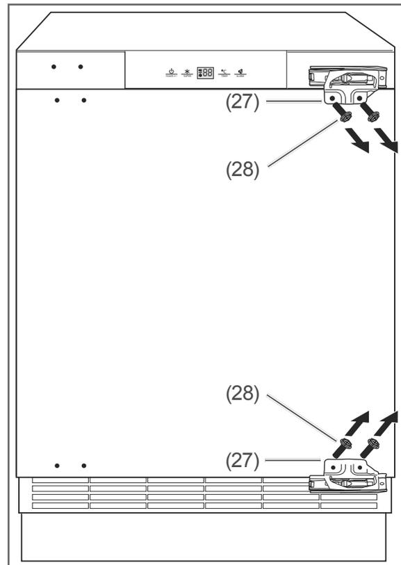
3. Lösen Sie Schrauben (28) an den Scharnieren (27).
