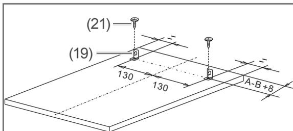
10. Befestigen Sie die Winkel (19) mit den Schrauben (21) an der Möbelfrontplatte.
