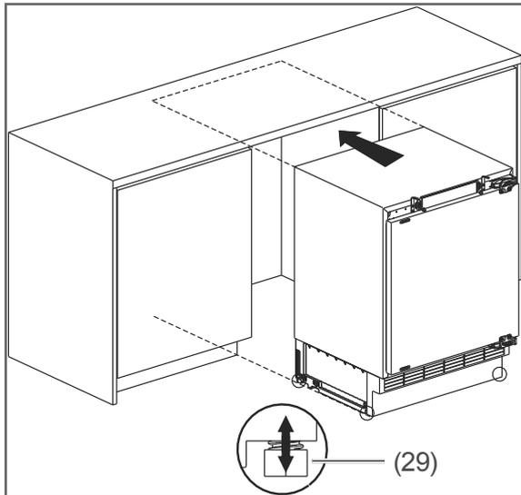
7. Richten Sie das Gerät aus, indem Sie die Stellfüße (29) auf die korrekte Höhe schrauben.
