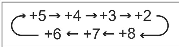
Die Temperatur wird mit jedem Drücken um 1 °C reduziert. Wenn die Einstellung +2 °C erreicht, springt die Anzeige bei erneutem Drücken auf +8 °C.
