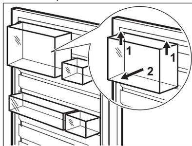
2. Entfernen Sie die obere Schiene, indem Sie sie an der Mitte fassen und anheben.
