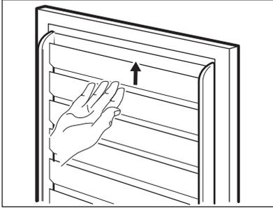
3. Schieben Sie die anderen Schienen nach oben, um sie zu entfernen (sie bilden ein Teil).
