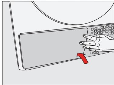
**i** Bitte platzieren Sie vorsichtig den Filterschwamm innerhalb der dafür vorgesehenen Abmessungen der Filterschublade, wie durch die Pfeile gezeigt. Dadurch können Sie ein Einklemmen des Filterschwammes verhindern, wenn die Filterschublade wieder geschlossen ist.
