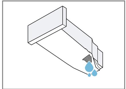
Prüfen Sie regelmäßig den Filter des Kondenswasserbehälters → Seite 39 und reinigen Sie einen verunreinigten Filter. Stellen Sie sicher, den Kondenswasserbehälter vor dem Betrieb des Geräts einzuschieben. → "Kondenswasserbehälter einschieben", Seite 30
