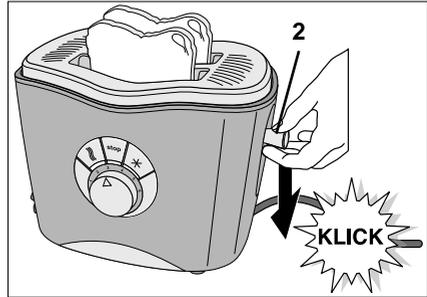
5. Bedienhebel **2** herunterdrücken, bis er mit hörbarem „Klick“ einrastet. Die Kontrollleuchte an der **stop**-Taste **5** leuchtet.
