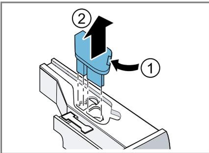
5. Den Deckel der Waschmittelschublade entlasten und entfernen.
