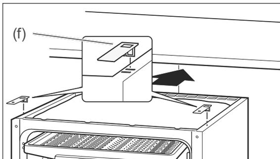
4. Stecken Sie beide Montagewinkel (f) in die vorderen Schlitze an der oberen Seite des Geschirrspülers, um später den Geschirrspüler an die Arbeitsplatte anschrauben zu können.
