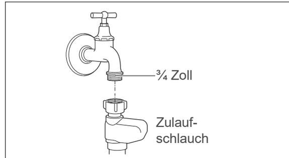
Für die Wasserversorgung benötigen Sie einen Wasserhahn mit einem 3/4 Zoll-Schraubanschluss.
