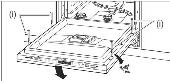
7. Entfernen Sie die 4 Schrauben an der Innenseite der Tür. Schrauben Sie die Möbelfrontplatte an diesen Positionen mithilfe der beiliegenden 4 Schrauben (i) fest.
