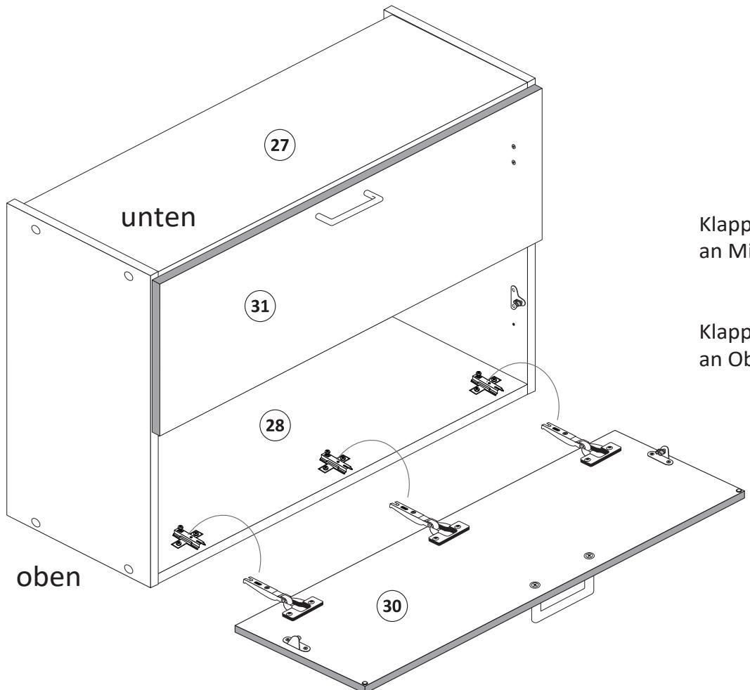
Klappe 31 mit Scharnieren 6 an Mittelboden 29 montieren!
