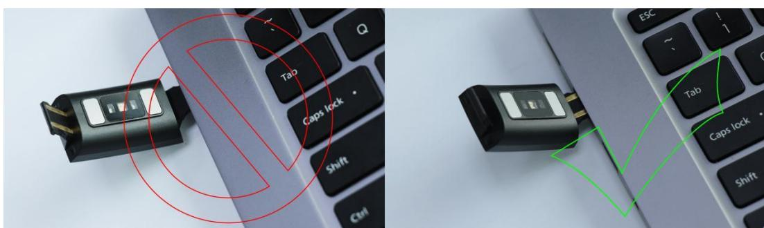
\*I due contatti della spina USB non possono entrare in contatto con il conduttore allo stesso tempo, poiche' causerebbero un corto circuito.
