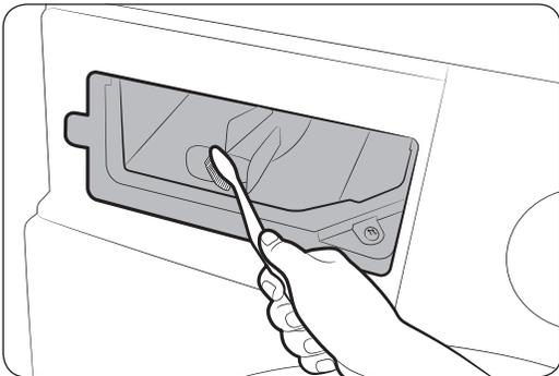
1. Ziehen Sie den Waschmittelbehälter heraus, während Sie gleichzeitig den **Entriegelungshebel** im Behälter herunterdrücken.
