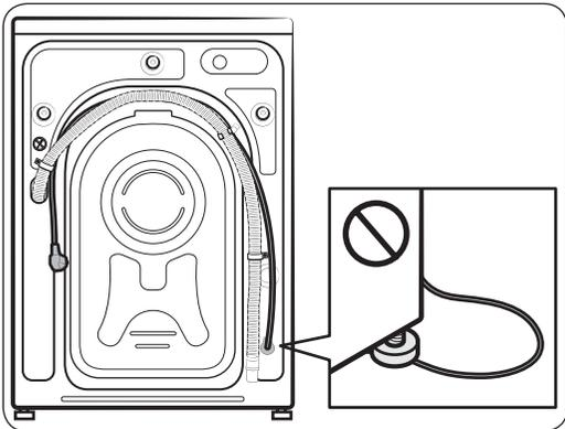
1. Schieben Sie das Gerät vorsichtig an die gewünschte Position. Vermeiden Sie eine übermäßige Krafteinwirkung, da die Nivellierfüße beschädigt werden könnten.
