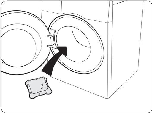
1. Legen Sie die Kapsel in der Nähe der Rückwand auf den Boden der leeren Trommel.
