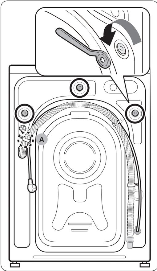
1. Suchen Sie die Transportsicherungen (in der Abbildung mit einem Kreis markiert) auf der Rückseite der Waschmaschine.
