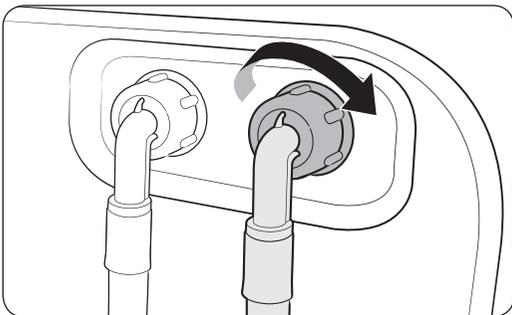
1. Schließen Sie das rote Ende des Warmwasserschlauchs an den Warmwasseranschluss auf der Rückseite der Waschmaschine an.
