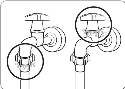
3. Öffnen Sie den Wasserhahn, und überprüfen Sie die Anschlüsse dann auf Lecks. Sollte tatsächlich Wasser austreten, müssen die Schritte 1 und 2 wiederholen.
