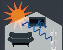
Der Ventilator «VIND» eignet sich durch seinen wendbaren Luftausblas für alle Jahreszeiten. Im Sommer kann die Luft nach oben ausgestossen werden, was für ein frisches Gefühl sorgt. Und im Winter sorgte er für eine angenehme Wärme im ganzen Raum, indem er die nach oben steigende warme Luft nach unten zurückführt.
