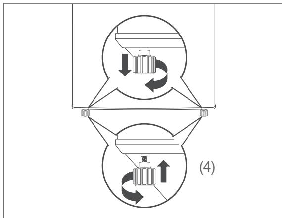
3. Gleichen Sie Unebenheiten des Untergrunds mithilfe der vier Schraubfüße aus.
