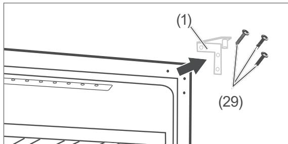
6. Lösen Sie die Schrauben (29) am oberen Scharnier für den Rechtsanschlag und nehmen Sie das Scharnier ab. Bewahren Sie Scharnier und Schrauben gut auf.
