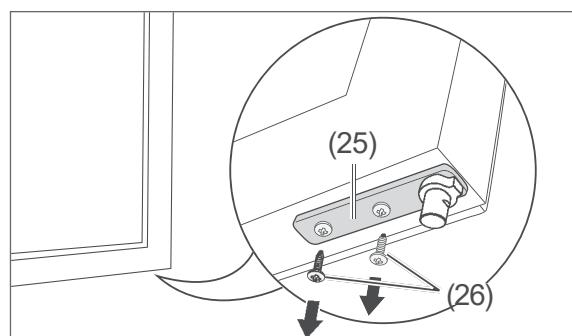
1. Lösen Sie die Schrauben (26) aus der Scharnierplatte (25) am unteren Rahmen der Glastür.
