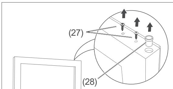
3. Lösen Sie die Schrauben (27) an der gegenüberliegenden Schmalseite des Rahmens der Glastür, und entnehmen Sie die Hülse (28).
