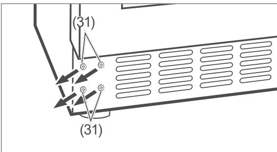
1. Lösen Sie die Schrauben (31) links unten am Geräterahmen.
