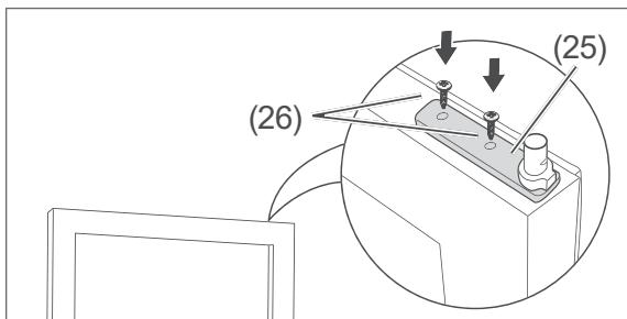
4. Setzen Sie die Scharnierplatte (25) an diese Stelle, und schrauben Sie sie mit den Schrauben (26) an.
