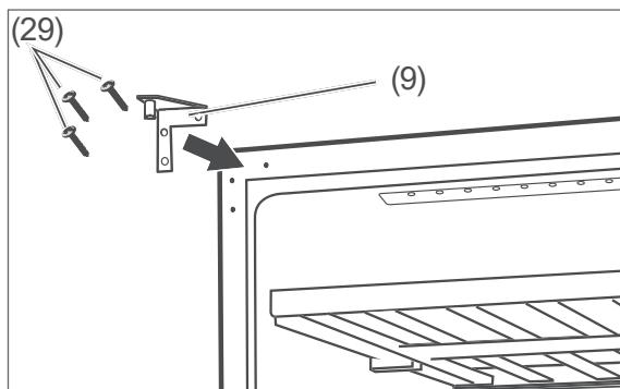
8. Schrauben Sie das obere Scharnier (9) für den Linksanschlag mit den Schrauben (29) an das Gerät an.
