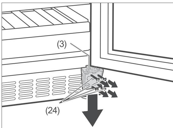
3. Lösen Sie die Schrauben (24) am unteren Scharnier (3), und nehmen Sie das untere Scharnier (3) ab.
