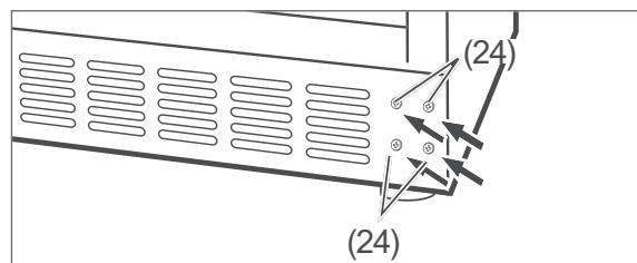
5. Schrauben Sie die Schrauben (24) wieder in die Löcher.
