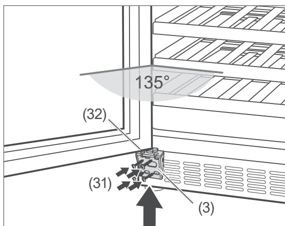
4. Setzen Sie das untere Scharnier (3) so gegen das Gerätegehäuse, dass die Achse (32) der Scharnierplatte (25) im linken Loch des unteren Scharniers (3) liegt, und schrauben Sie das untere Scharnier (3) mit den Schrauben (31) fest.
