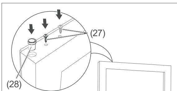
5. Schrauben Sie die Schrauben (27) an der gegenüberliegenden Schmalseite des Rahmens der Glastür fest, und setzen Sie die Hülse (28) in die dortige Aufnahme ein.
