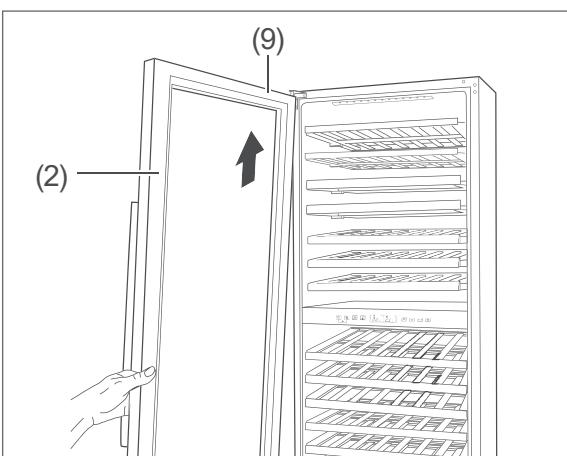
2. Drehen Sie die Glastür (2) so, dass die Scharnierplatte an der unteren Seite der Glastür ist, und setzen Sie sie in das obere Scharnier (9) für den Linksanschlag ein.
