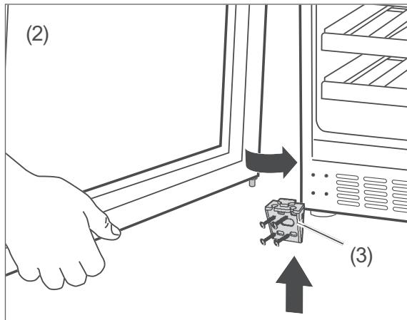
3. Setzen Sie die Glastür (2) gegen den Rahmen des Geräts.
