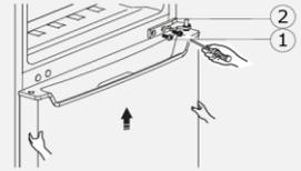
10. Die in der Mitte angebrachten Schraubloch-Abdeckungen links entfernen und rechts anbringen.
