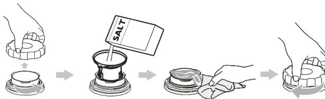
1. Unterkorb entfernen, Deckel des Salzbehälters abschrauben.
