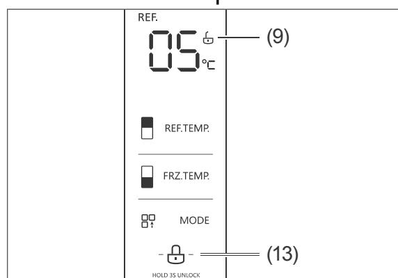
Um Einstellungen ändern zu können, müs-sen Sie zunächst die Sensortasten entsper-ren. Berühren Sie hierzu die Sensortaste UNLOCK (13) so lange, bis die Anzeige erscheint.
