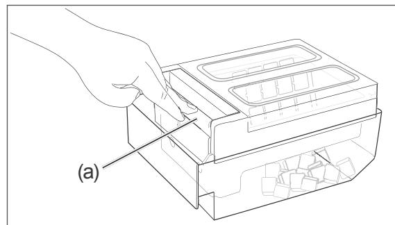
3. Zum Entnehmen der Eiswürfel drücken Sie die Taste (a) kräftig herunter. Die Eiswürfelformen werden dadurch umgedreht und die Eiswürfel fallen in den Vorratsbehälter.
