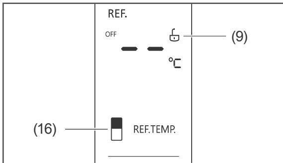
2. Schalten Sie den Kühlbereich ab, indem Sie die Sensortaste REF.TEMP. (16) so lange berühren, bis im Display zwei Striche sowie „OFF“ erscheinen. Kurze Zeit später werden abwechselnd die Temperatur des Gefrierbereichs sowie „—“ angezeigt.
