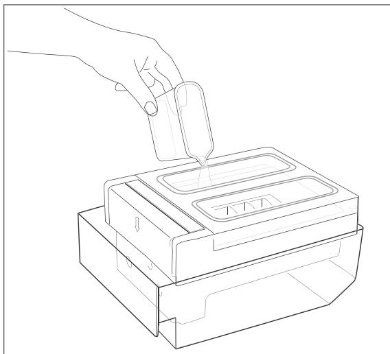
1. Füllen Sie die Eiswürfelformen zu  $\frac{3}{4}$  mit frischem Trinkwasser.
