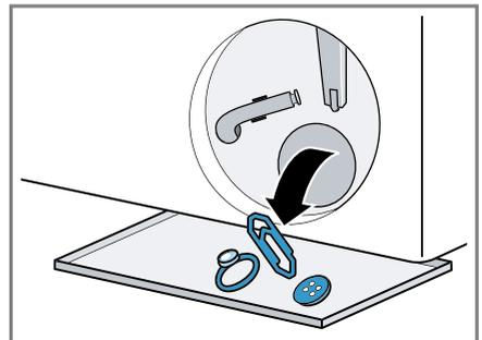
Der Pumpendeckel besteht aus zwei Bauteilen die zur Reinigung auseinandergebaut werden können.
